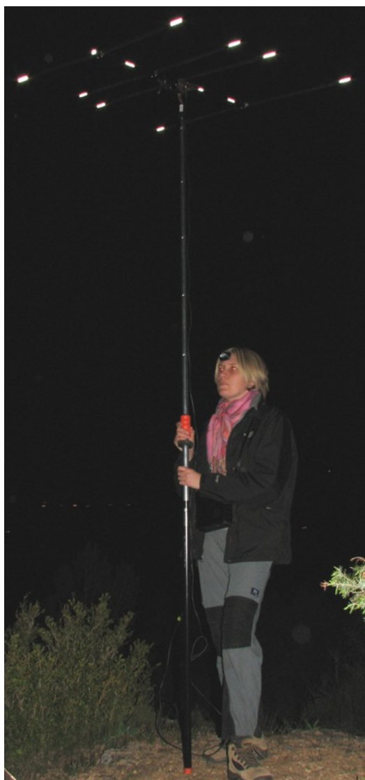
Poste mobile : antenne et mât télescopique
