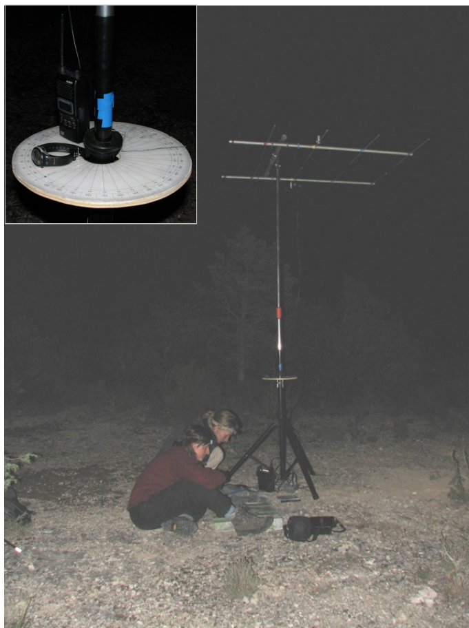
Antenne Null Peak et détails de la rosace (prise d'azimut) et du matériel nécessaire à ce poste
